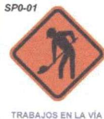
Esta señal se empleará para advertir la proximidad a un tramo de la vía que se ve afectado por la ejecución de una obra que perturba el tránsito por la calzada o sus zonas aledañas
